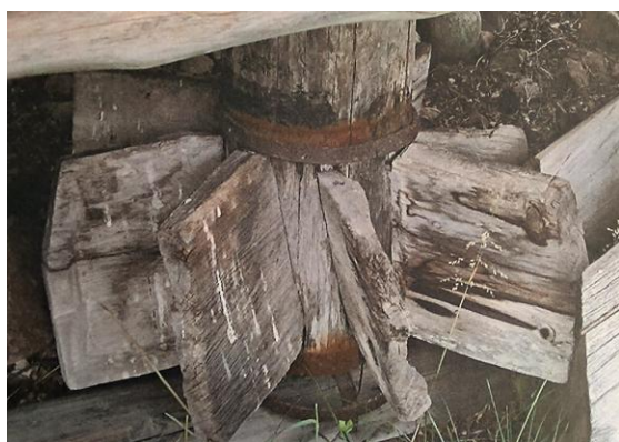
Exempel på skvaltkvarn. Kvarnhuset stod bredvid bäcken. Vid malning leddes vattnet ifrån bäcken via trärännan till höger, in under kvarnen till kvarnhjulet till vänster. Foto Lars Carlsson 2022.
